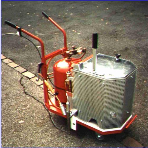
Das Heissvergussgerät Dicorel 3001 wurde speziell zum Vergiessen von Fugen oder wild verlaufenden, aufgeweiteten Rissen gebaut. Die zentral positionierte Ausgussdüse und die hohe Beweglichkeit der Gerätes, erlaubt ein exaktes Nachfahren an der Fuge oder am Riss. Selbst bis zu einer Wand hin verlaufende Fugen können vergossen werden.
